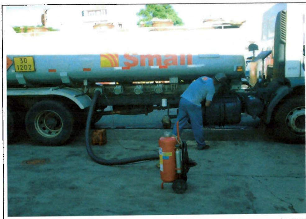
Figura 3 – Descarregamento de combustível do Caminhão para o tanque subterrâneo de combustíveis, e extintor locado próximo a atividade.
