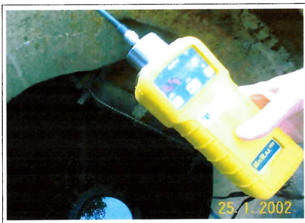
Figura 7 Monitoramento de Gases em poços de visita, possivelmente em rede de águas pluviais.
